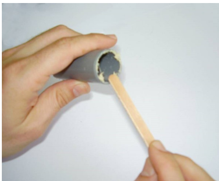
Слика 3. Наношење слоја брзовезујућег лепка на исечени пластични сегмент
