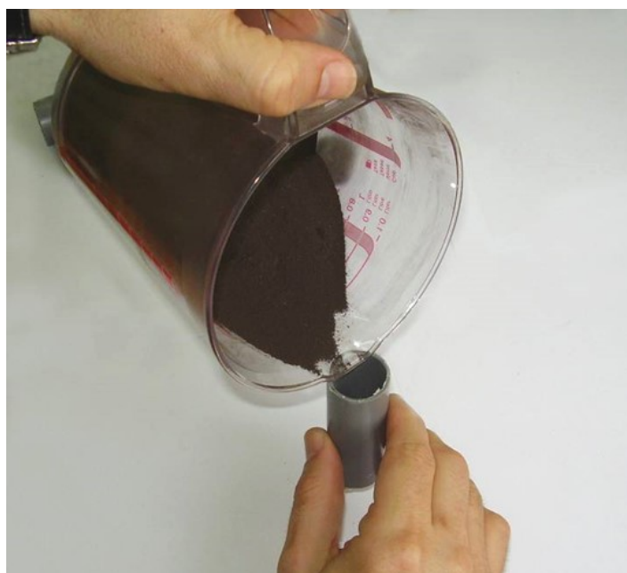
Слика 5. Пуњење пластичне патроне неексплозивном горивом мешом
